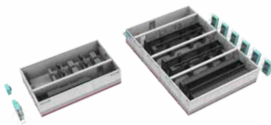
FusionModule1000B IT-CT混合部署场景
